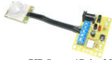
PIR Sensor / Relay Module (BPE # IRS-0300)
